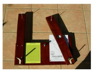
Il est constitué d'une base (AB), d'un viseur fixe (AF) dans une direction perpendiculaire à la base, et d'un viseur (BM), mobile autour d'un axe B; (BM) sert à mesurer un angle.
