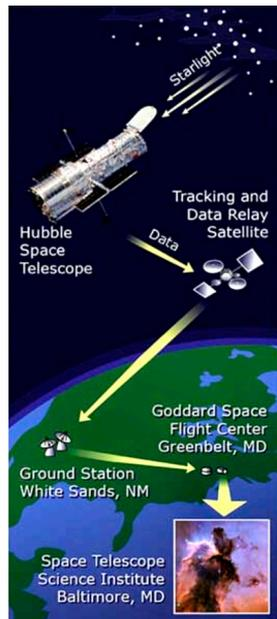
Fig. 4. Cheminement des données acquises par le HST. © NASA
