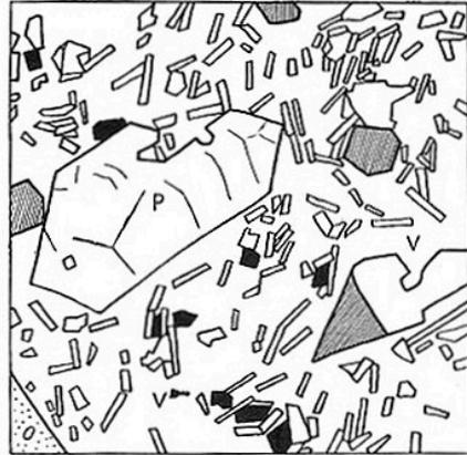
Fig. 20 – Microphotographie d'une lame mince de basalte.
